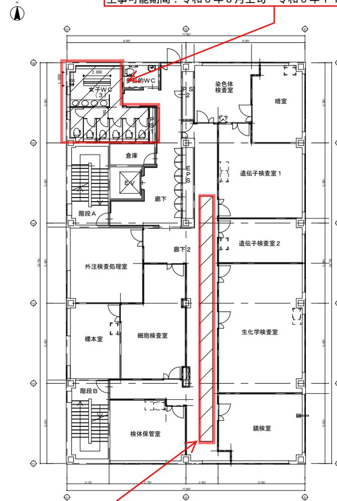
臨床検査棟 3階平面図 (改修後) S=1/200
