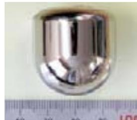
Neues Metallglas aus Zirkonium (Zr) (max. Durchm.: 30 mm).
