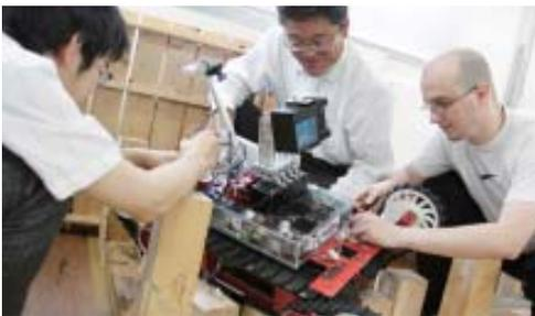
「kenaf(ケナフ)」(探査用クローラロボット)。安全な場所から無線 LAN を用いて遠隔操縦し、3次元形状などを計測できる。
